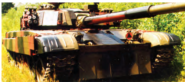
Polski czołg PT-91 Twardy z szybko montowanymi blokami kaset reaktywnych ERAWA-1 i ERAWA-2 - III generacji opracowanymi przez prof. dr. hab. inż. Adama Wiśniewskiego Znaczenie słowa ERAWA - Explosive Reactive Armour Wiśniewski Adam
